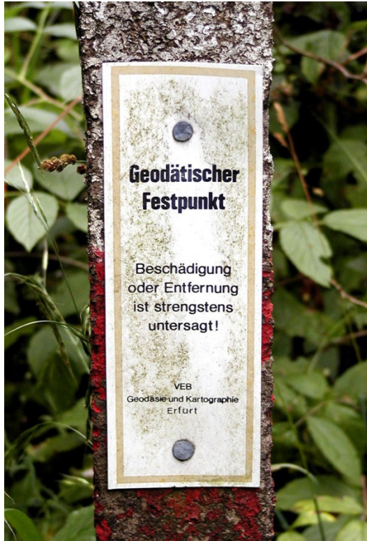
Abb. 3. Ein älterer Geodätischer Festpunkt der VEB für Geodäsie und Kartographie in Erfurt kennzeichnet den mit 492,1 m höchsten Punkt im Arbeitsgebiet (siehe Abb. 2).
